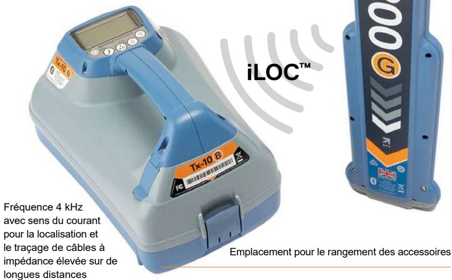
Fréquence 4 kHz avec sens du courant pour la localisation et le traçage de câbles à impédance élevée sur de longues distances
